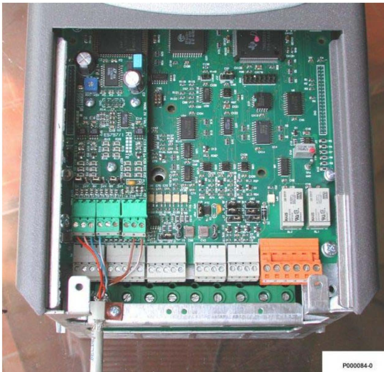
Figura 70: Conexión del cable del encoder
