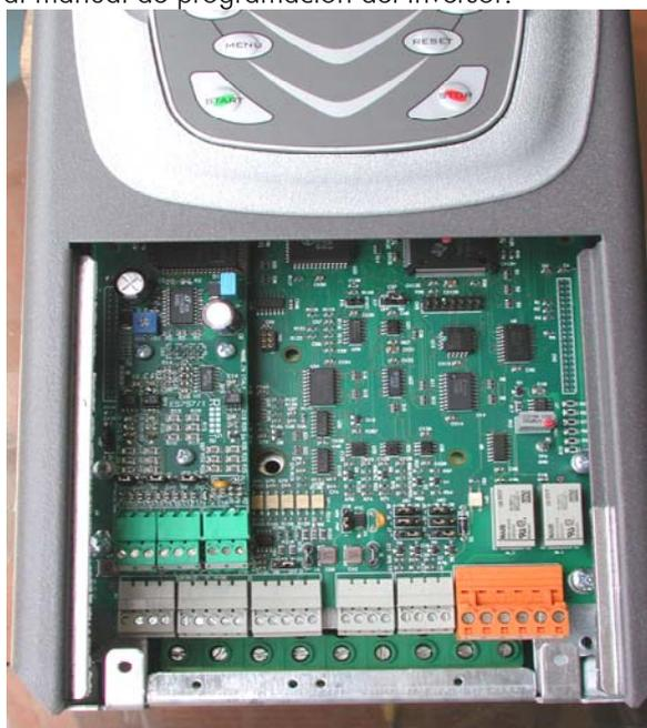
Figura 64: Tarjeta de encoder fijada en la ranura
