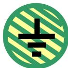
Conectar siempre el inversor a una línea de tierra que cumpla con las normativas en vigor. Para reducir al mínimo las perturbaciones conducidas y radiadas que puede emitir el inversor, es preferible conectar el conductor de tierra del motor directamente con el inversor, con un recorrido paralelo a aquello de los cables de alimentación del motor, y de allí a la instalación eléctrica.
