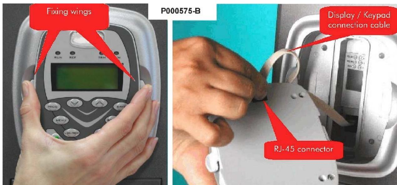
Figura 54: Separación módulo teclado
